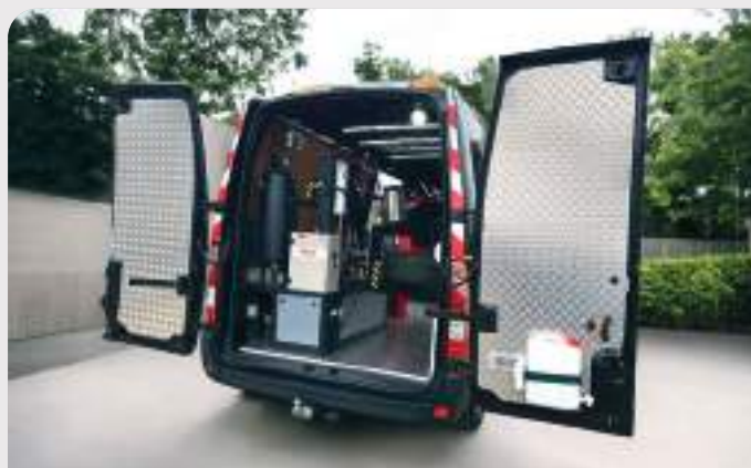
FixiBox 2-en-1 : démonte-pneus VL/VUL + compresseur intégré
