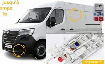
Pour se faire, le véhicule doit simplement nous être livré d'une prise de mouvement sur la boîte de vitesse (option constructeur) et Guernet\* s'occupe alors du reste : de l'installation au raccordement avec une armoire électrique dédiée et spécialement développée pour la mobilité.
